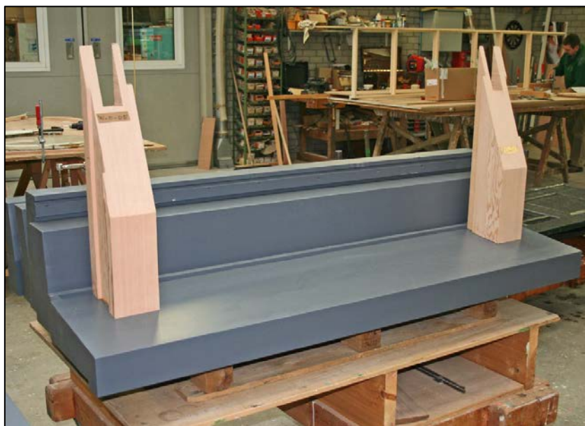
Onderdorpel met delen van kozijnstijlen, vervaardigd volgens URL 4001, gereed om op de bouwplaats te verwerken.
