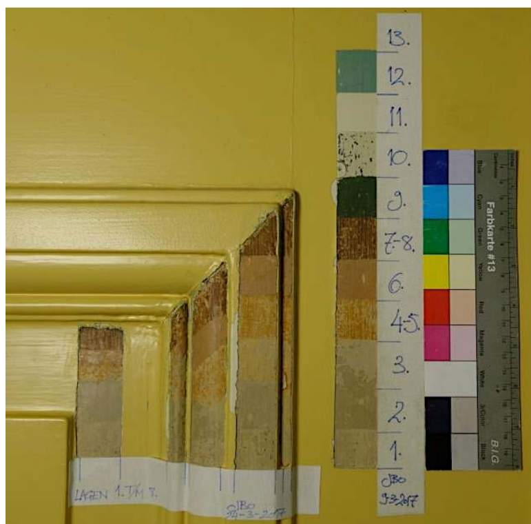
Kleurtrap met in totaal 13 verflagen.
