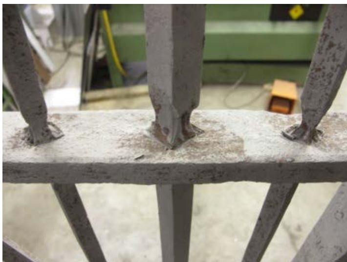
Figuur 5. Aangetaste aangegoten verbinding.
