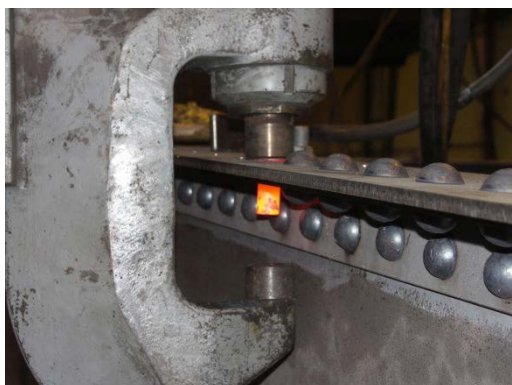
Figuur 11. Apparatuur voor het aanbrengen van zwaardere klinknagels.
